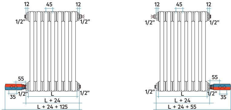
**TOMAS MONOTUBO INFERIOR Código T24:** Incluye 1 manguito inferior de 1/2" SOLO compatible con los modelos TESI 3 columnas y 5 columnas. Se debe indicar elemento de entrada/salida. NO NIPLABLE
