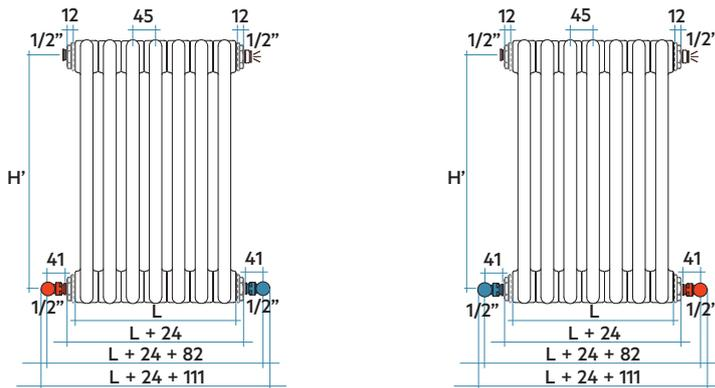
Para baterías Tesi con altura superior a 1000 mm y menos de 15 elementos, se debe pre-instalar un diafragma en el lado de la entrada del agua. Ver Cód. T08.
